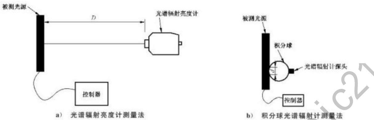
图 2 光谱辐射亮度计与被测光源发光表面间的距离
