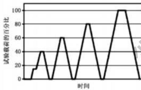
图 2 加载曲线(加载—保载—卸载)
